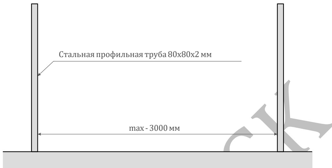
1. При установке на грунтовое основание металлические опоры предварительно заглубляют на глубину промерзания (600 мм) и надежно бетонируют для обеспечения устойчивости и долговечности конструкции.
