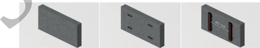
Направляющие располагаются на расстоянии не более 400 мм друг от друга (вертикально/горизонтально) и фиксируются к основанию с шагом 350-500 мм
